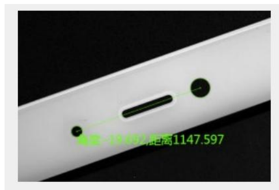
图 2 产品尺寸检测示意图
